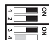
**SW2+SW1 ON** konumunda iken, **SW3 ON** yapılınsa, kalibrasyon sırasında belirlenmiş olan **span** noktası **YUKARI** kayar (yükseılır, span noktasına yaklaşır.) İstenilen değere geldiği zaman switch off konuma alınır.
