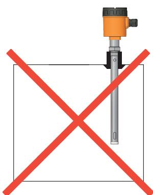
Transmitterin boyun bağlantısı tortu birikmesi olmaması için ölçüm tüpünün etrafında olmamalıdır.
